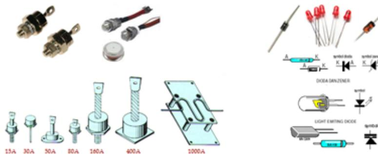
Gambar 1 Dioda daya dan dioda sinyal
