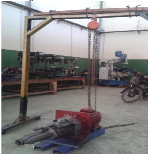
Gambar 12. Mesin Penguji dilakukan penyetelan dengan bantuan Katrol
